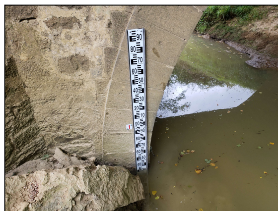
Exemple d'échelles de mesures installées sur les stations de Lupiac et Sabazan
